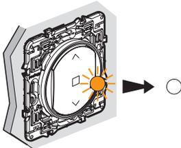
Le voyant de l'**interrupteur pour volet roulant câblé** fourni dans le pack s'éteint. **La centralisation de votre volet roulant est fonctionnelle.**
