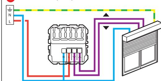
L'interrupteur pour volet roulant est compatible avec les volets roulants à butée mécanique ou électronique, contrôlés par un interrupteur filaire classique pour volet roulant. Ils ne sont pas compatibles
