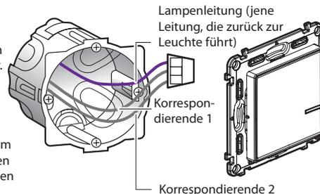
Verwenden Sie eine **Verbindungsklemme** um die 3 Drähte zu verbinden (die 2 Korrespondierenden und die Lampenleitung).
