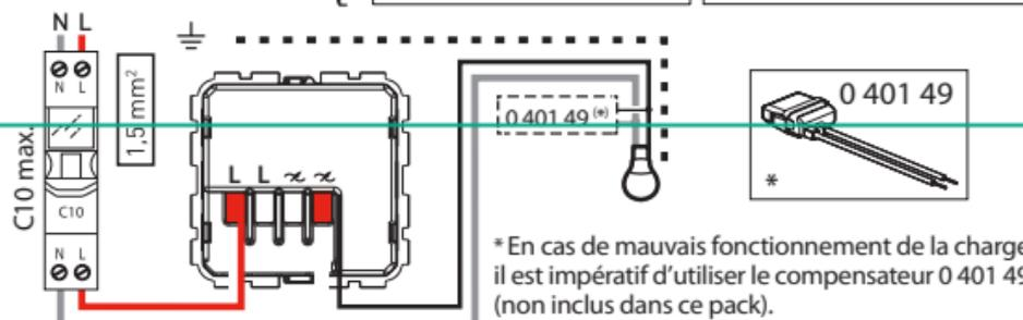
\* En cas de mauvais fonctionnement de la charge, il est impératif d'utiliser le compensateur 0 401 49 (non inclus dans ce pack).
