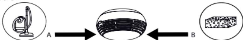
A: Dépoussiérez les ailettes à l'aide d'un aspirateur ou un chiffon antistatique.
