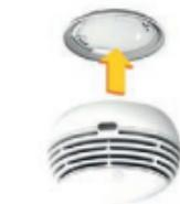
7 - Faites une rotation dans le sens horaire jusqu'au verrouillage
