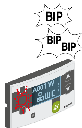
Le pupitre de la salle infirmière signale la chambre en appel et émet une alarme sonore plus rapide.
