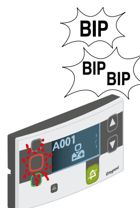
Le pupitre de la salle infirmière signale la chambre en appel et émet une alarme sonore plus rapide.
