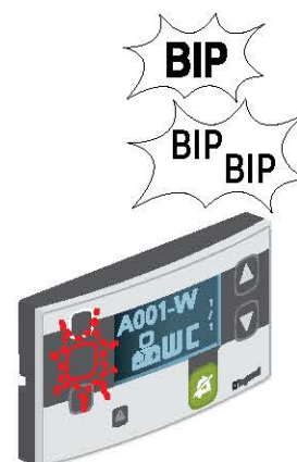
La consola de la sala de enfermería señala la habitación que efectúa la llamada y emite una alarma sonora más rápida.
