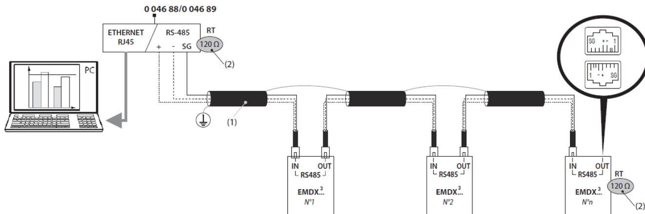
Schema di collegamento RS485 Modbus con Mini Web Server:
