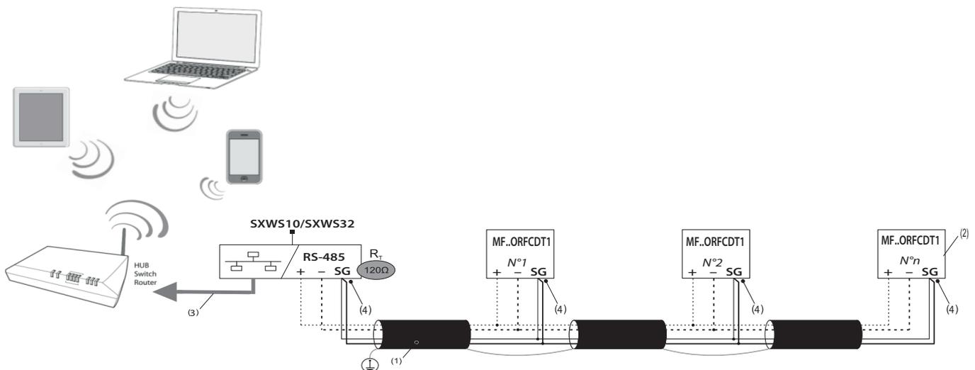
((1) RS485 : Utilisation prescrite de câble Belden 9842, Belden 3106A (ou équivalent) pour une longueur maximum du bus de 1000 m ou de câble de Catégorie 6 (FTP ou UTP) pour une longueur maximum de 50 m.
