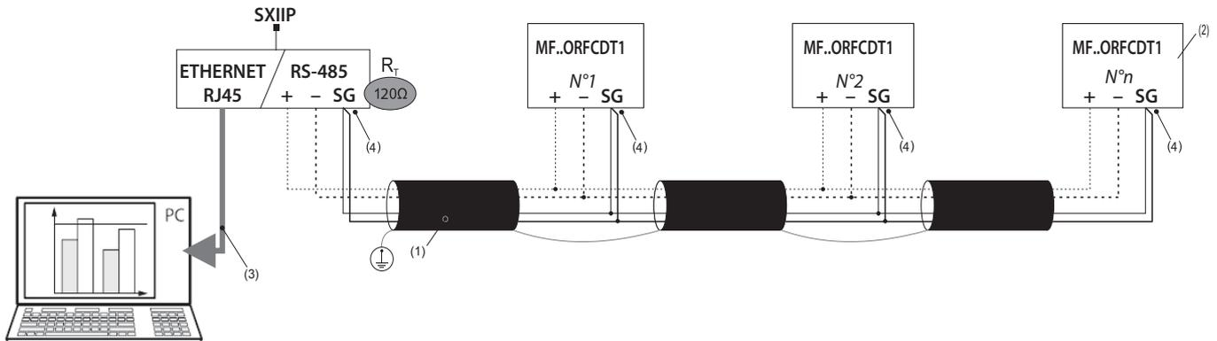
Schéma de branchement RS485 Modbus avec Mini Web Serveur:
