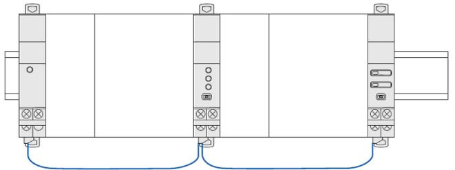
**Mise en œuvre** : avec cette façon de câbler, le cache plastique présent à l'arrière de tous les modules Nemo SX ne doit pas être enlevé.
