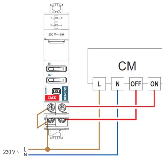
. Association avec une Commande motorisée pour une commande ON/OFF cyclique.
