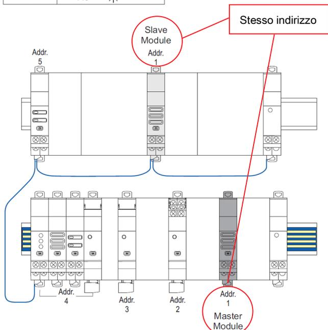
**Nota:** per cambiare il "Modulo Master" di riferimento di un modulo impostato come "Slave", è sufficiente assegnare al modulo "Slave" l'indirizzo del nuovo "Modulo Master".
