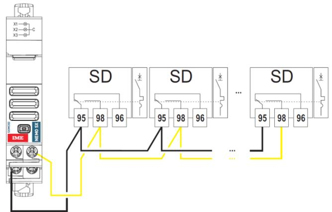
. Associazione con ausiliario elettromeccanico per Contattori, Teleruttori e Relè passo-passo.
