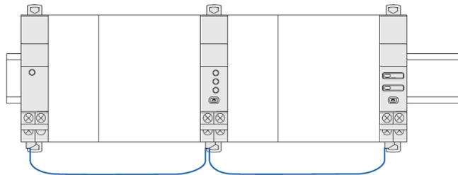
**Mise en œuvre :** avec cette façon de câbler, le cache plastique présent à l'arrière de tous les modules Nemo SX ne doit pas être enlevé.
