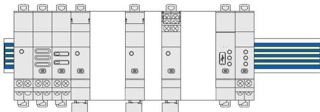
**Mise en œuvre :** dans cette configuration, le cache plastique présent à l'arrière de tous les modules Nemo SX doit être enlevé afin que la transmission des données puisse se faire.
