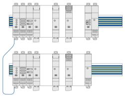
Moduli interconnessi tramite cavi di comunicazione sulla prima rotaia DIN e con una guida comunicante sulla rotaia DIN in
