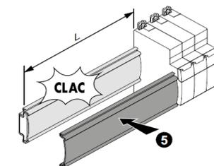
Clipser le cache plastique sur les parties non utilisées du rail communicant
