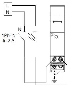
**Note :** Lorsqu'il y a plusieurs modules d'alimentation dans un système, seul un doit être relié à la terre
