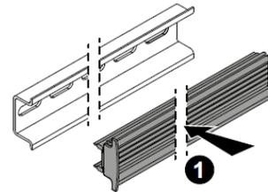
1. Clipser le rail communicant sur le rail DIN
