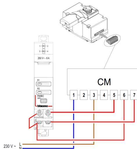
. Associazione con Comando a Motore per MEGABREAK fino a 6300 A (art. M8MT024C/048C/110C/230C/415/480) con comandi ON/OFF separati.
