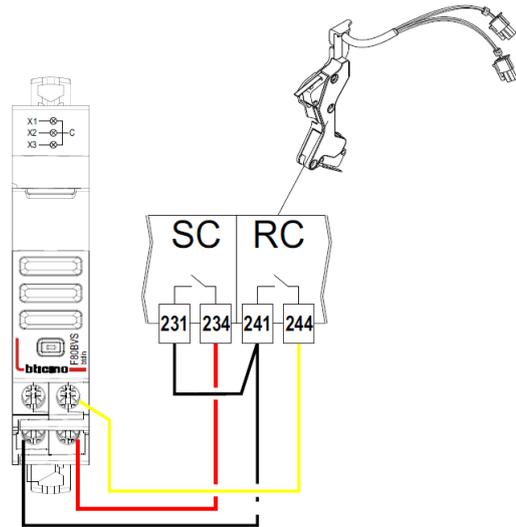
. Associazione con ausiliario elettromeccanico per MEGATIKER o MEGABREAK in versione estraibile (es. art. M8POS per MEGABREAK / M7B10 per MEGATIKER) o ausiliario di altro costruttore.
