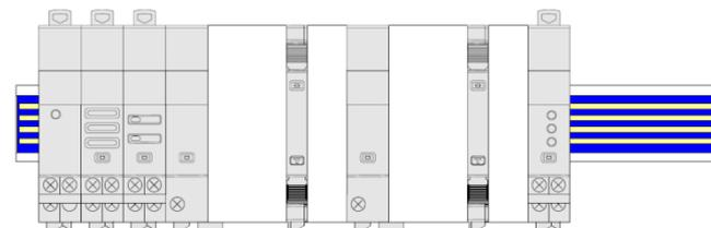
**Note installative:** con questa configurazione, la copertura in plastica delle porte di comunicazione sul retro del modulo di EMS BTDIN deve essere rimossa.
