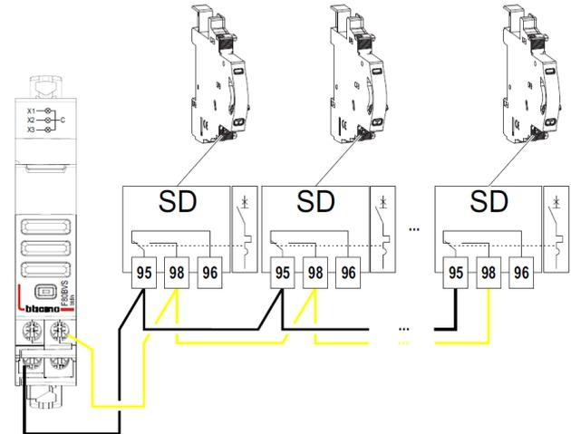
Per gli ausiliari di tipo segnale di allarme per MEGATIKER, utilizzare per ciascun ausiliario art. M7X01 i morsetti 51 (al posto del 95) e 54 (al posto del 95)
