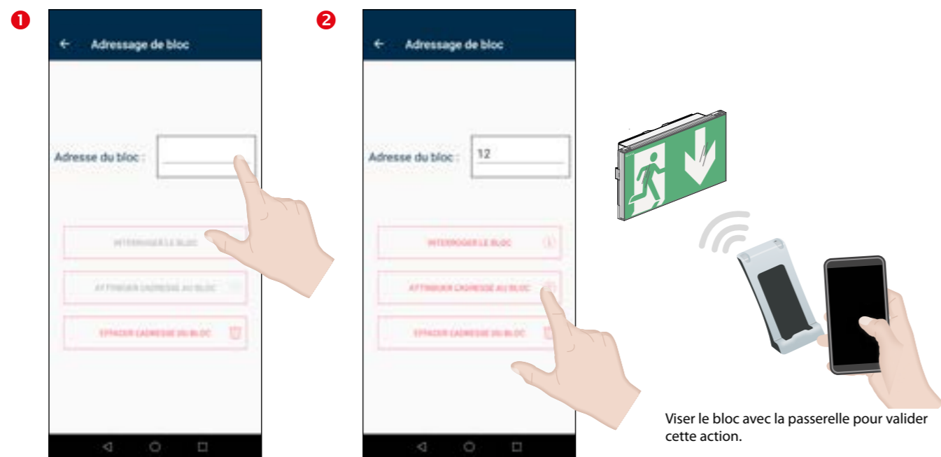
Attribuer un numéro d'adresse puis terminer l'action par "Attribuer l'adresse au bloc".
