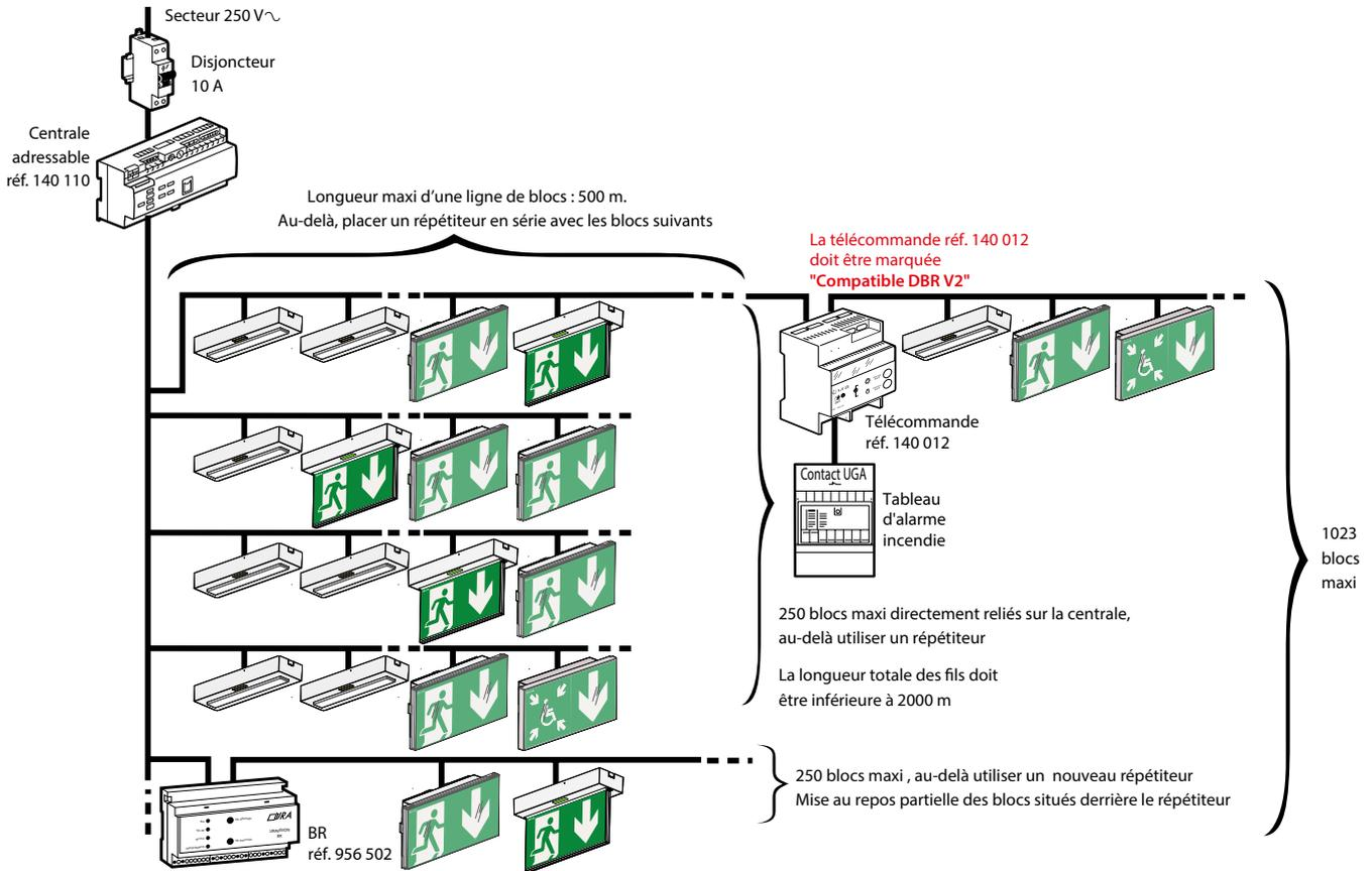
**4.2.3 Cablage d'une interface avec BAEH + BAES et/ou DBR**
