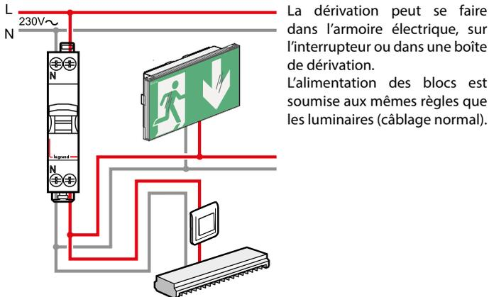
La norme NF C 15-100 admet à l'article 521.6.1 que le raccordement secteur et la télécommande soient dans le même câble ou conduit.
