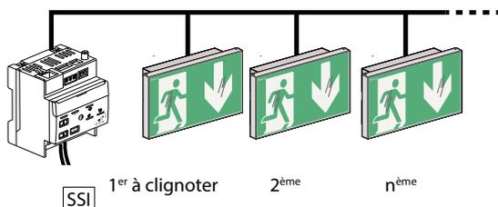
Ce paramétrage doit être fait avec la passerelle de configuration réf. 140 132 et l'application CloseUp. Cette action permet d'attribuer un numéro d'ordre qui indique la position du bloc dans la file.
