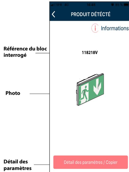
**Etape 2 :** Cliquer sur "DÉTAIL DES PARAMÈTRES" pour avoir accès à la liste complète des paramètres et à des informations complémentaires. Durant cette étape il faut maintenir la passerelle en direction du bloc interrogé, le chargement des paramètres est visualisable sur l'écran du téléphone.
