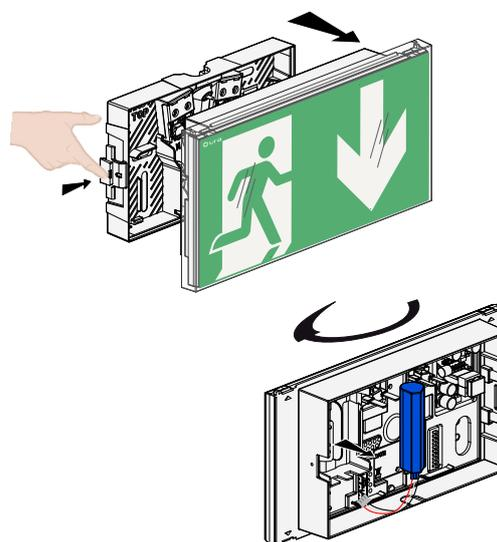
Les accumulateurs doivent être remplacés lorsque le bloc autonome ne satisfait plus à sa durée assignée de fonctionnement.
