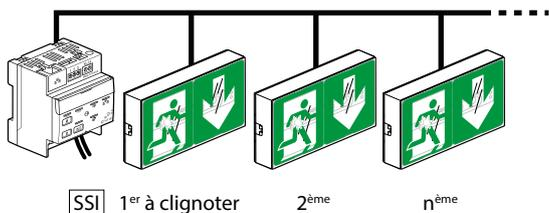
Ce paramétrage doit être fait avec la passerelle de configuration réf. 140 132 et l'application CloseUp. Cette action permet d'attribuer un numéro qui indique la position du bloc dans la file.
