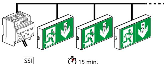
**Nota:** Il est possible d'arrêter le mode visibilité augmente quand la boucle SSI est refermée par deux appuis successifs sur la touche "Extinction" des télécommandes réf. 140 130 ou 140 131.
