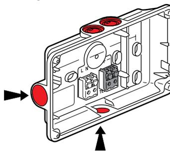
A la livraison 2 trous pour le passage de câbles sont percés, ils sont à équiper (en fonction de l'arrivée du câble) l'un avec le presse-étoupe l'autre avec le bouchon.
