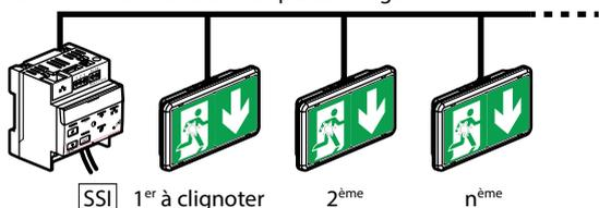
Ce paramétrage doit être fait avec la passerelle de configuration réf. 0 882 40 et l'application CloseUp. Cette action permet d'attribuer un numéro qui indique la position du bloc dans la file.
