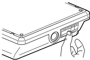
Cette étiquette de maintenance réf. 0 609 00) doit être apposée de manière visible sur chaque bloc autonome d'éclairage de sécurité en y inscrivant la date de mise en service du bloc.
