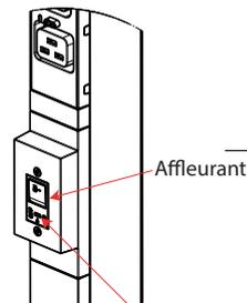
Un tournevis plat est nécessaire pour déclencher volontairement le MCB
