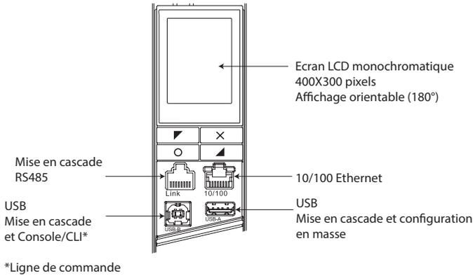
Le contrôleur NODE est connecté sur la base et est remplaçable à chaud
