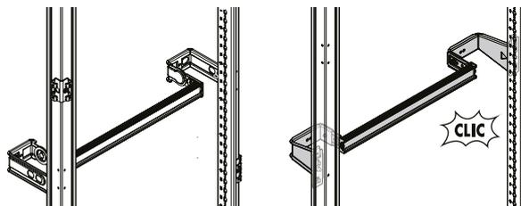
Réf. 3DIN045 / 3DIN060 : fixation avec vis sur les montants de structure des armoires largeur 450 ou 600 mm
