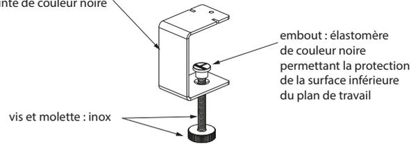
Cet accessoire permet la fixation des blocs bureau sur une table épaisseur de 6 à 40 mm.
