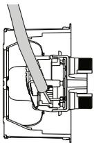
Durch die Beschränkung der Verformung des Koaxialkabels vermeidet die hintere Verbindung Impedanzunterbrechungen und erhält so die Leistung
