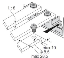
Capacité de raccordement de la borne Type 2 – Avec porte-fusibles
