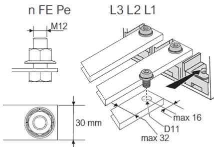
Capacité de raccordement de la borne Type 3 – Avec porte-fusibles
