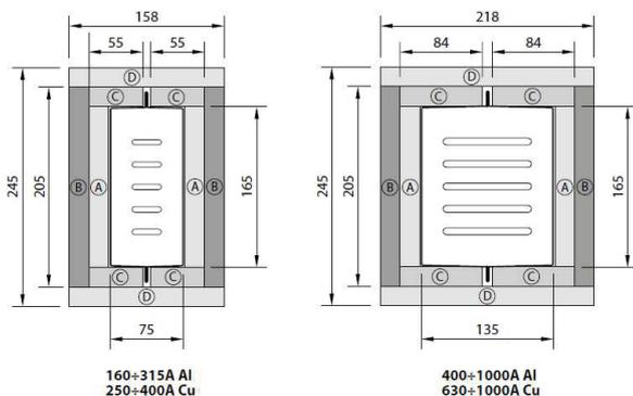
Lorsque le système de canalisations traverse des cloisons ou des plafonds ignifuges, il doit être équipé de séparations coupe-feu appropriées.
