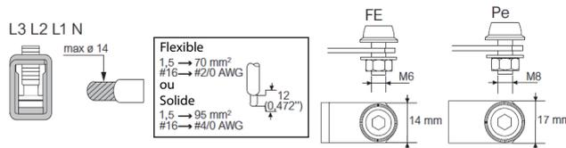
Capacité de raccordement de la borne Type 1 – Avec porte-fusible
