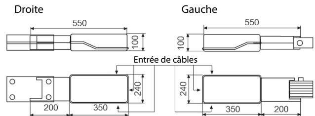
Les blocs d'alimentation de 160 et 250 A sont équipées de bornes pour des câbles allant jusqu'à 150mm<sup>2</sup>; pour des intensités plus élevées, la connexion des câbles au bloc d'alimentation nécessite des cosses de câble à fixer sur les répartiteurs fournis.
