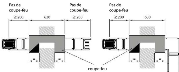
Après installation, boucher tous les interstices avec un matériau conforme aux réglementations en vigueur pour la classe de résistance au feu requise.
