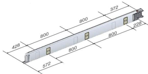
De cette manière, les boîtiers de dérivation sont centrés avec l'armoire contenant les racks auxquels ils doivent être connectés (voir le catalogue pour les articles dédiés détaillés). Cela permet, en cas de panne, une identification et une intervention rapides sur le rack non fonctionnel.
