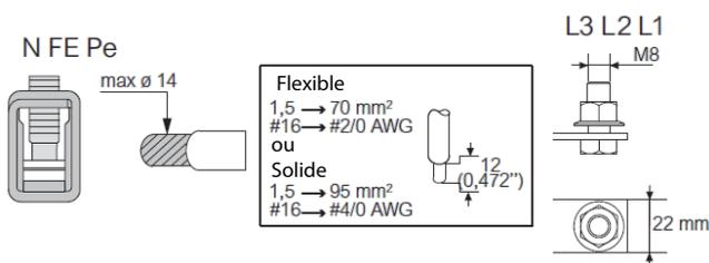
Capacité de raccordement de la borne Type 1 – Vide
