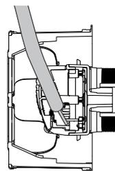
La conexión trasera limita la deformación del cable coaxial, evitando la rotura de impedancia y preservando el rendimiento.
