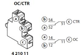
Dans l'espace A, il est possible d'insérer 1 déclencheurs à émission de courant, ou alternativement 1 déclencheurs à minimum de tension. L'espace B ne peut recevoir qu'un contact auxiliaire standard (OC) ou un signal de défaut (CTR).
