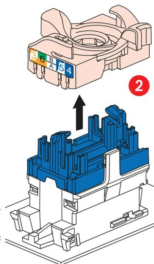
Este sistema permite separar fácilmente los pares antes de montarlos en el conector.
