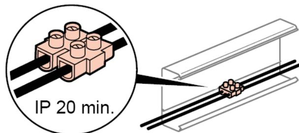
A l'intérieur des goulottes, connection des conducteurs en utilisant un domino pour respecter l'IP 20 mini.
