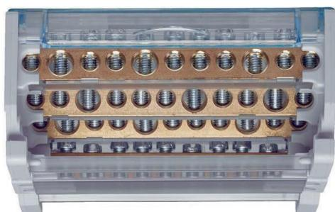
Точки подключения также достаточно разнесены, что позволяет использовать стандартные наконечники с изоляцией без проблем. Прозрачные изолирующие перегородки обеспечивают максимальную безопасность каждой латунной шины. Кроме того, встроенная в эту защиту система предотвращает случайное откручивание винтов неподключенных соединений.
