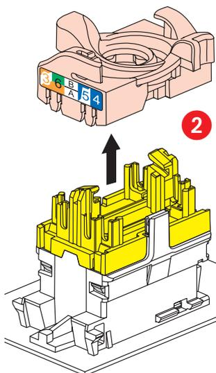
Ce système permet d'épanouir facilement les paires avant montage sur le connecteur.
