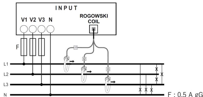
. La longueur du câble entre le/les tore(s) Rogowski (Cf. § Côtes d'encombrement), en plus des rallonges, laisse la possibilité de mettre le module de mesure sur n'importe qu'elle rangée, dans la limite de cette longueur. De ce fait, il est possible de positionner le module de mesure sur une rangée différente de l'appareil qu'il mesure.
