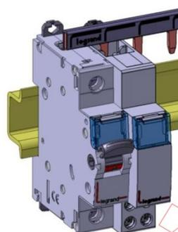
2. Tirer l'appareil vers l'avant afin de le dégager du rail
