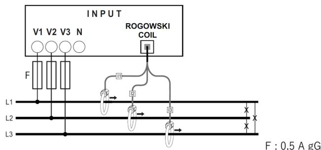
En triphasé avec 4 câbles et 3 transformateurs (3N-3E) :
