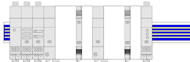
**Mise en œuvre :** dans cette configuration, le cache plastique présent à l'arrière de tous les modules EMS CX<sup>3</sup> doit être enlevé afin que la transmission des données puisse se faire
