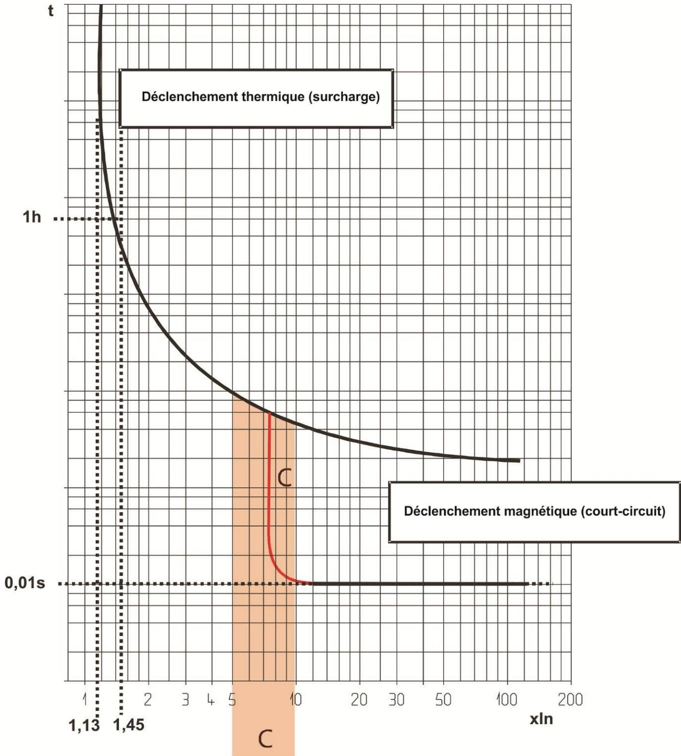
Déclenchement thermique à température ambiante = 30°C
