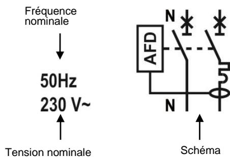
. Les bornes aval du pôle neutre sont repérées par un « N » moulé à proximité de la tête de vis.
