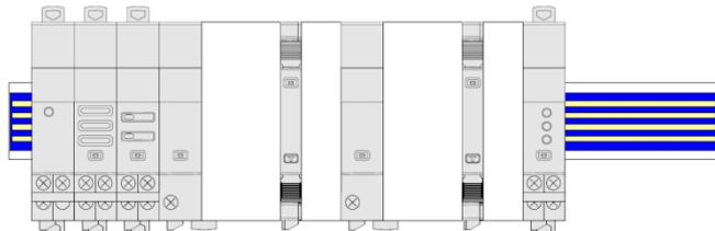
**Mise en œuvre :** dans cette configuration, le cache plastique présent à l'arrière de tous les modules EMS CX<sup>3</sup> doit être enlevé afin que la transmission des données puisse se faire
