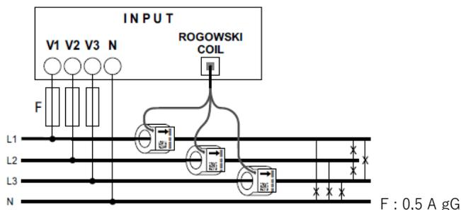
. La longueur du câble entre le/les tore(s) Rogowski (Cf. § Côtes d'encombrement) laisse la possibilité de mettre le module de mesure sur n'importe quelle rangée. De ce fait, il est possible de positionner le module de mesure sur une rangée différente de l'appareil qu'il mesure.
