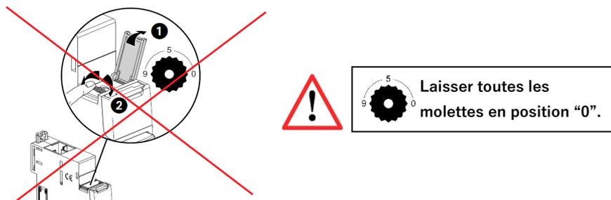
. Il n'est pas nécessaire d'attribuer une adresse via le bouton rotatif ; **doit être laissé dans la position d'usine** → « 0 ».
