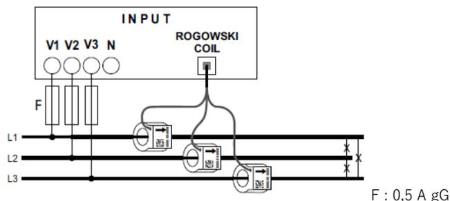
En triphasé avec 4 câbles et 3 transformateurs (3N-3E) :
