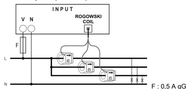
**Note :** les 3 circuits monophasés mesurés doivent être issus de la même phase.
