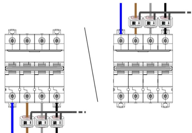
. Les tores doivent être positionnés dans le sens du courant (**une flèche est dessinée sur le tore**)
