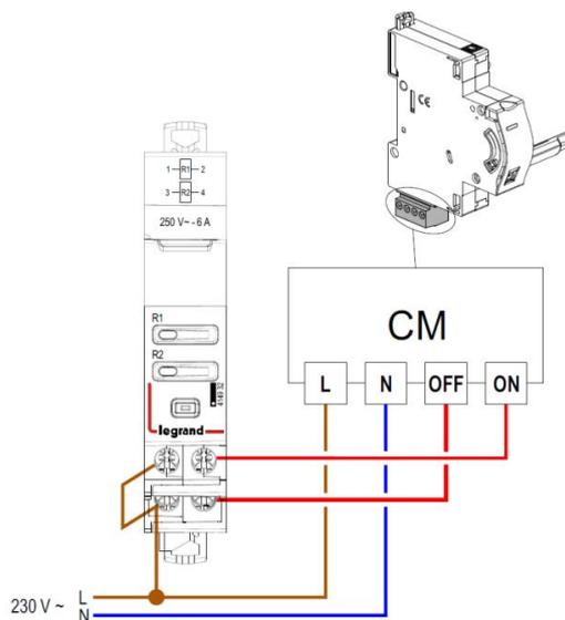
. Association avec une commande motorisée DX<sup>3</sup> (réfs. 4 062 90/91/92) pour une commande ON/OFF cyclique.
