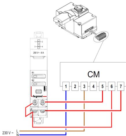
. Association avec une commande motorisée DMX<sup>3</sup> 1600 (réfs.0 281 20/21/23) ou commande motorisée DMX<sup>3</sup> 2500/4000/6300 (réfs. 0 288 34/35/37) pour une commande ON/OFF indépendants.
