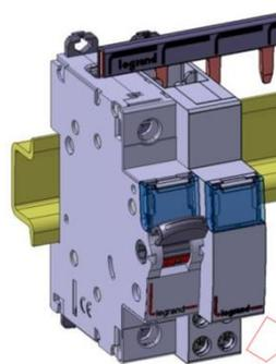
2. Tirer l'appareil vers l'avant afin de le dégager du rail
