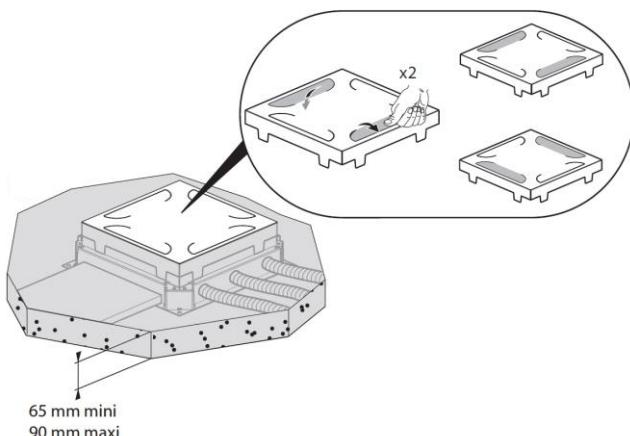
2) Mise en place des conduits avant le coulage de la dalle
