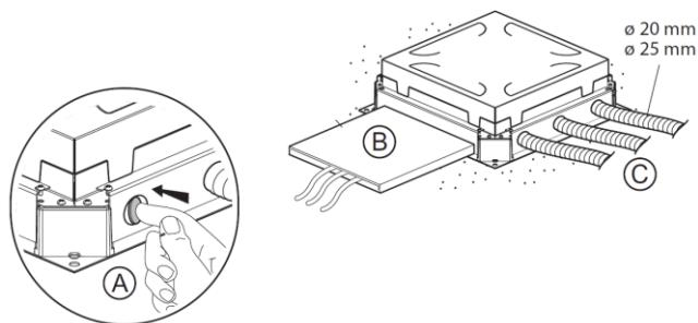
3) Coulage de la dalle en béton
