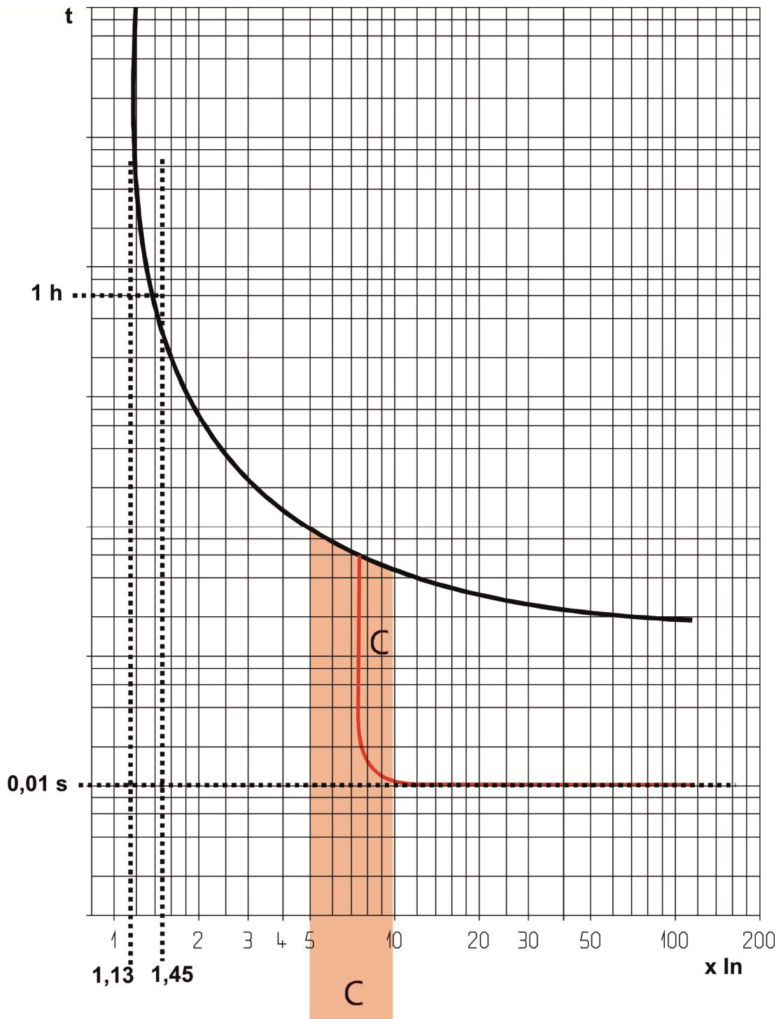
Déclenchement thermique à température ambiante = 30°C
