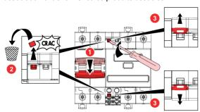
. Il est possible de verrouiller le dispositif de protection (Disjoncteur ou IS) associé au MSI par cadenas (référence 4 063 13 ou 0 227 97) et par support cadenas (référence 4 063 03)
