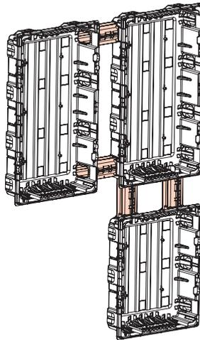
■ **7.2 Pattes de fixation pour cloison sèche réf. 4 017 24**
