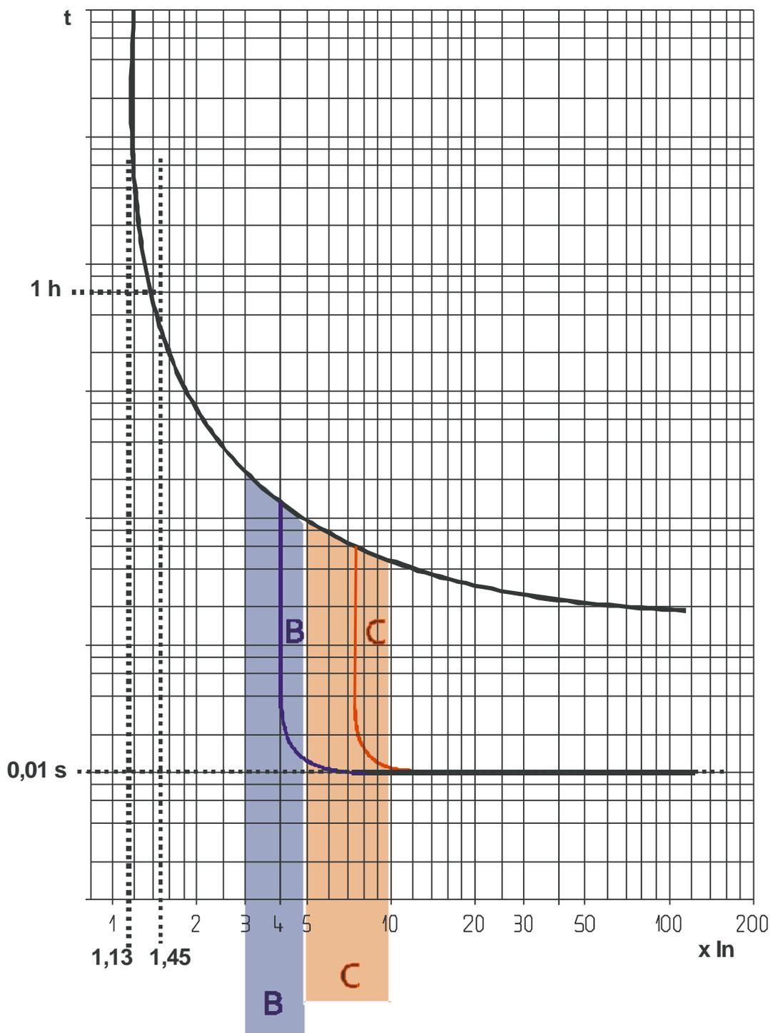
Срабатывание теплового расцепителя при температуре окружающего воздуха 30 °С
