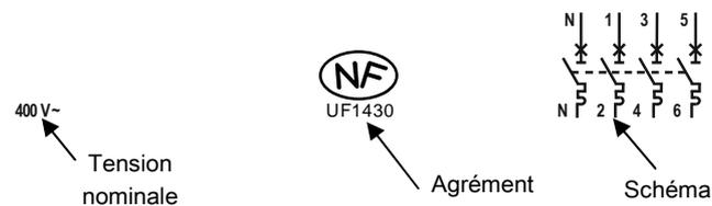
. Les bornes amont et aval du pôle neutre sont repérées par un « N » moulé à proximité des têtes de vis.
