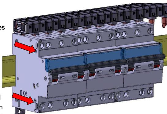
Tirer l'appareil vers l'avant afin de le dégager du rail
