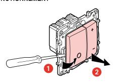
Pour intialiser les différents types d'utilisations, déclipser les doigts puis appuyer sur les touches indiquées dans le tableau pendant 2 secondes.
