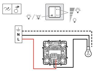
Bornes à vis Capacité des bornes : 2 x 2,5 mm² Couple de serrage : 0,8 Nm Longueur de dénudage : 8 mm Tournevis : plat de 4 mm.
