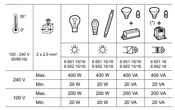
(\*) Utiliser uniquement des transformateurs prévus pour fonctionner avec des inter électroniques.
