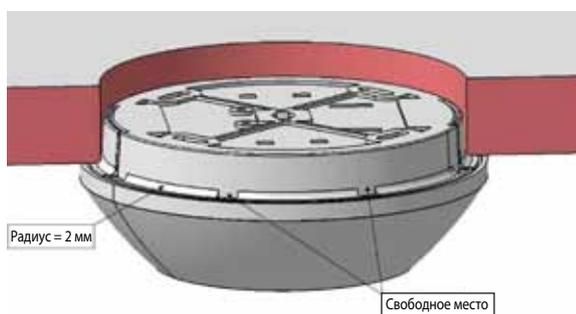
Диаметр коронки 102 мм, подвод проводов снизу
