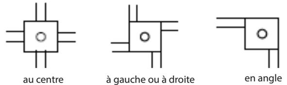
Grille de fixation à l'intérieur de la boîte, accepte les vis Ø 3 mini et Ø maxi.
