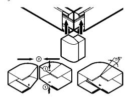
Permet la jonction en angle extérieur de deux morceaux de profilé de même section :
