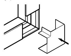
Permet la jonction en angle plat de deux morceaux de profilé de même section :
