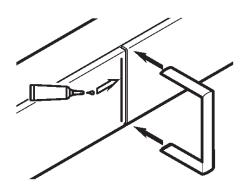
Montage du joint par clipsage sur le fond du profilé et collage sur 1 seul couvercle (colle non fournie)
