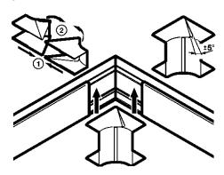
Permet la jonction en angle intérieur de deux morceaux de profilé de même section :
