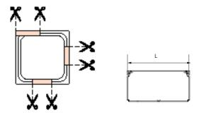
Fixation murale assurée par 4 points avec rattrapage d'aplomb et de la planéité du mur (fixation des boites de dérivation avec 12 vis non fournies)
