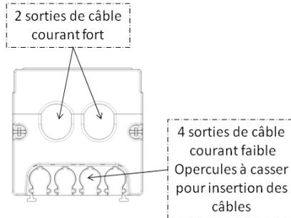
Les câbles RJ peuvent être attachés avec des colliers colring en utilisant les trous prévus.
